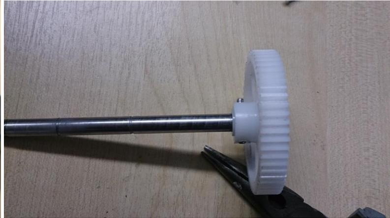
Zum Wechseln des Zahnrad pressen sie den Sicherungsstift aus Zahnrad und Welle.
