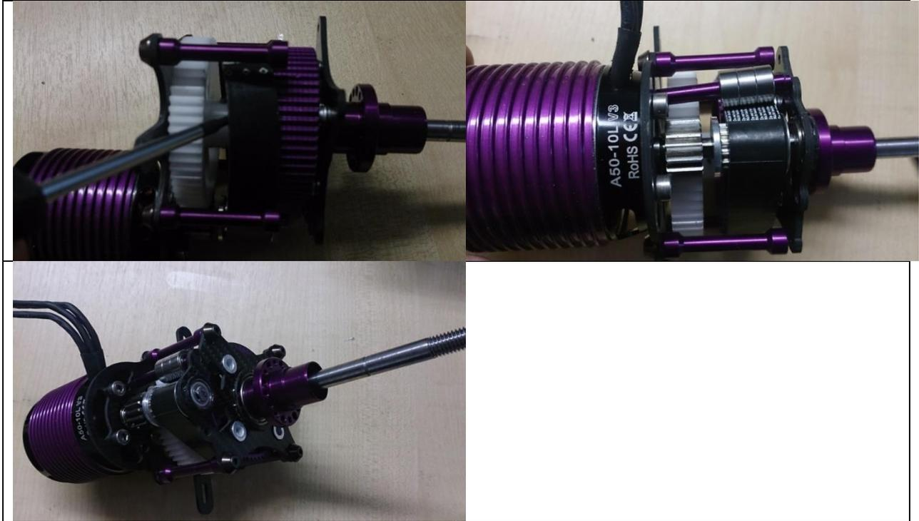
Abschließend setzen sie den Sicherungsring ein.
